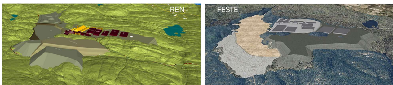
Figur 11 viser FESTE's worst-case simulering med bruk av 4,0 km 2 i Bærevann til høyre. REN's figur til venstre viser konseptet etter 80 års drift på kun 2,5 km 2 .
