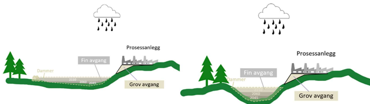
Figur 2 (REN) viser hvordan naturlig topografi kan utnyttes for å bygge deponiet i høyden, og dermed redusere det totale arealbeslaget
