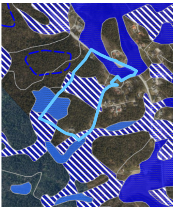
Figur 8 Illustrasjon. Stedvis stor sannsynlighet for marin leire innenfor planområdet, markert med blått og blå/hvis skravur. Fra NVEs kartgrunnlag.
