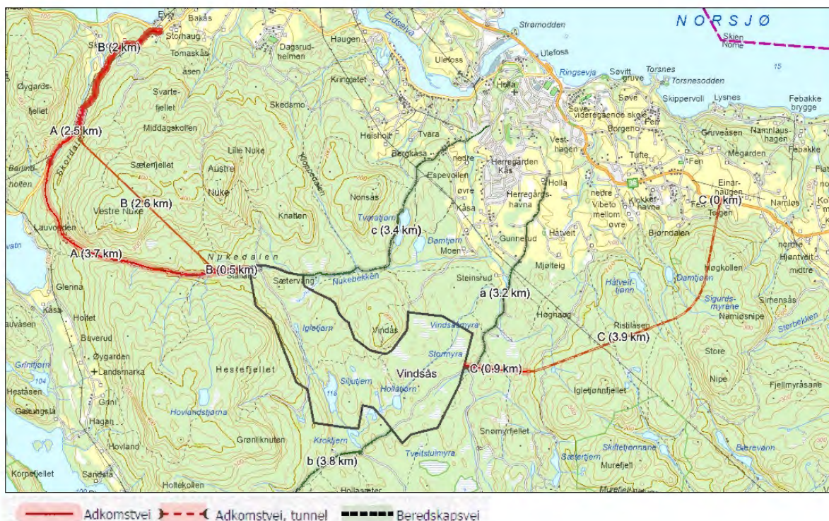
Figur 3.6 Kartet viser avgrensing av Vindsås-alternativet med mulig adkomstveger / tunnel og knutepunkt til eksisterende veg. I tillegg vises mulige beredskapsveger.
