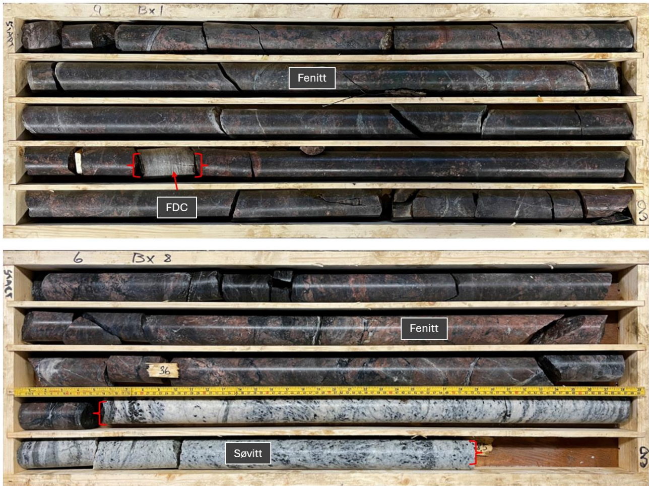
Figur 12: Fenitt er mørk og rødlig. Søvitt er lys med mørke malmtråder. FDC er grålig til mørk med tråder, stedvis rustforvitret. Den øverste kassen viser første 5 meter av NO_6, mens den nederste kassen viser siste 5 meter av NO_6 [2].
