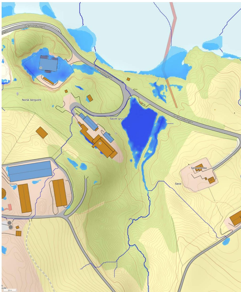
Figur 3 Vannveier nær tiltaksområdet. Stikkør for hovedbekken er fjernet i Scalgo for å simulere hvor vannet vil gå ved eventuell underkapasitet ved flom.
