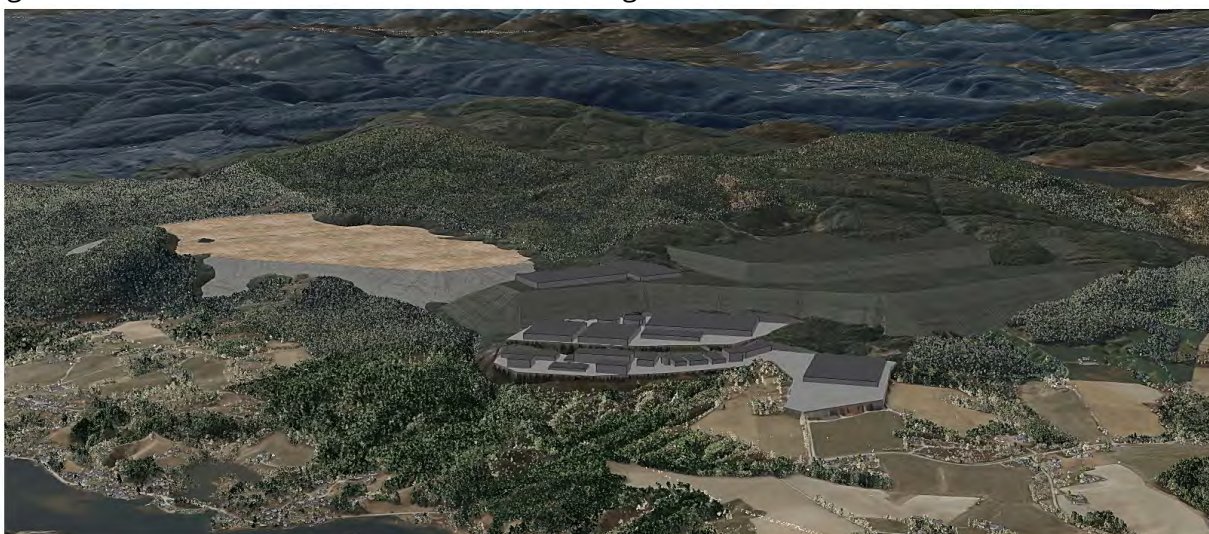
Figur 1.2 Illustrasjonen er sett fra nordøst i fugleperspektiv, og viser hvordan Dagsrud-området kan utnyttes til mineralpark. Illustrasjonen er vist uten revegetering av dam med fine masser, men med en naturlignende farge for grovmassedeponiene for å vise at disse skråningene kan revegeteres.
