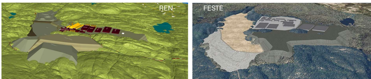
Figur 1 viser FESTE's worst-case (t.h.) simulering med bruk av 4,0 km 2 og 94 millioner m 3 masse i Bærevann. REN's figur til venstre viser REN's konsept for mineralpark etter 80 års drift på kun 2,55 km 2 . Merk Jøndtvedtjønna for referanse oppe til høyre i begge figurer.
