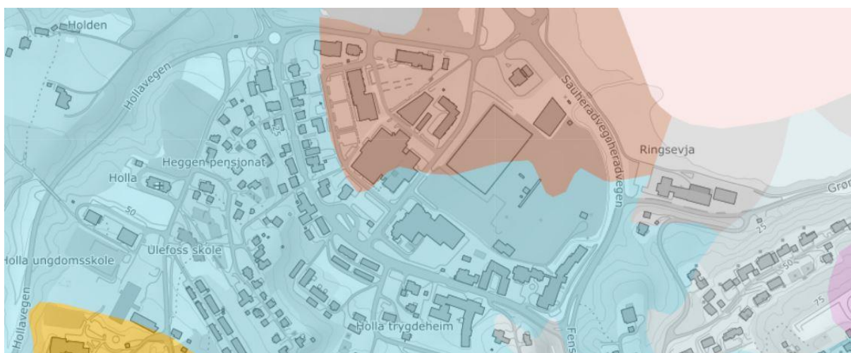
Figur 9: Kartutsnitt fra Norges geologiske undersøkelse (NGU) som viser type løsmasser i område rundt Ringsevja. Brune flater viser torv/myr og blå flater viser områder med tykk havavsetning.
